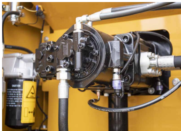
Модель основного насоса: K7V125D Объем: 2x130 мл Максимальный расход: 2x273 л/мин Давление: 34.3 МПа
