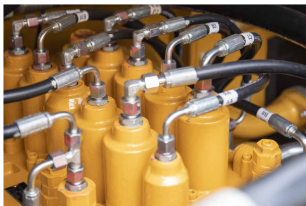
Модель распределителя: KMX15RB-ACE Номинальный расход: 300 л/мин Номинальное давление: 37.7 МПа
